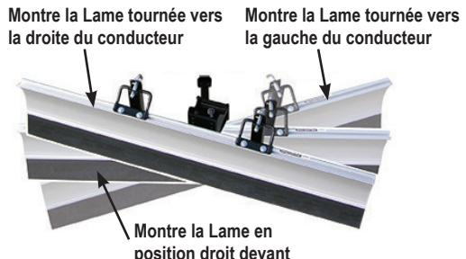
B) La lame peut être fixée dans la position abaissée pour une utilisation dans des conditions plus difficiles de neige ou de nivelage de sable, petit graviers, etc. L'utilisation les goujons dans la position maintenue abaissé n'est pas recommandé pour le gazon.
