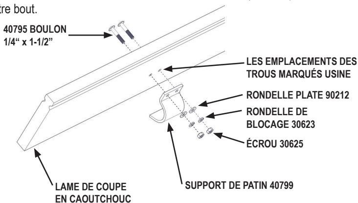
**CONSEILS:** Lorsque installé le support de patin doit s'aligner égal ou légèrement au dessus du bas du caoutchouc.
